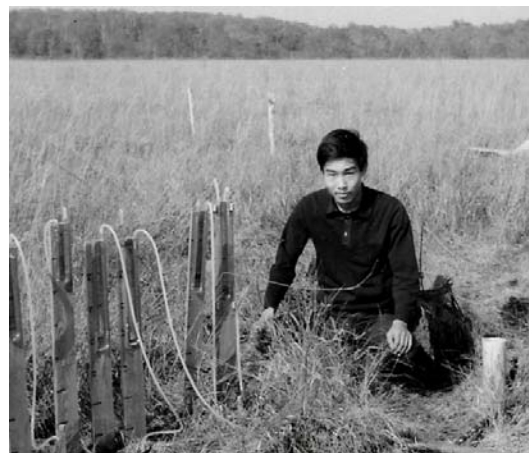
写真 1-1 水銀マンノメータによる深さ別 pF 測定 (1969 年 北海道中標津町大規模草地改良事業)
